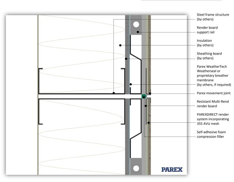
System: PAREXDIRECT onto Steel Frame
