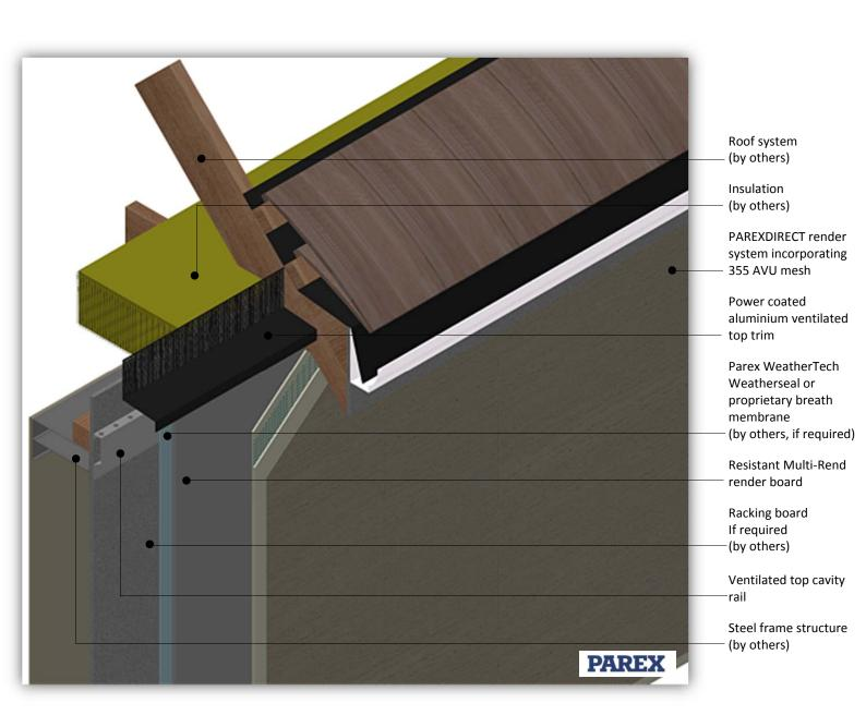
System: PAREXDIRECT onto Steel Frame
